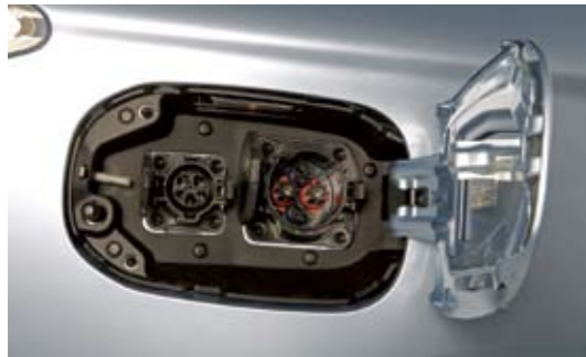
▲ Con la toma de enchufe convencional, las baterías del PHEV se cargan en 5 horas. Con la de carga rápida, se cargan al 80 por ciento en aproximadamente 30 minutos.
