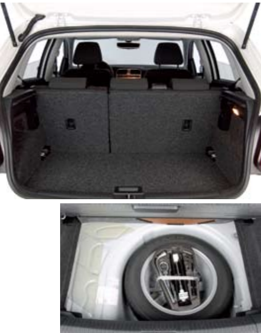
▲ Maletero de 280 litros, ampliable a 952 si abatimos la segunda fila, dotada de respaldo divisible 60:40 en los acabados Advance y Sport. La rueda de repuesto, de medida normal, también es de serie.
