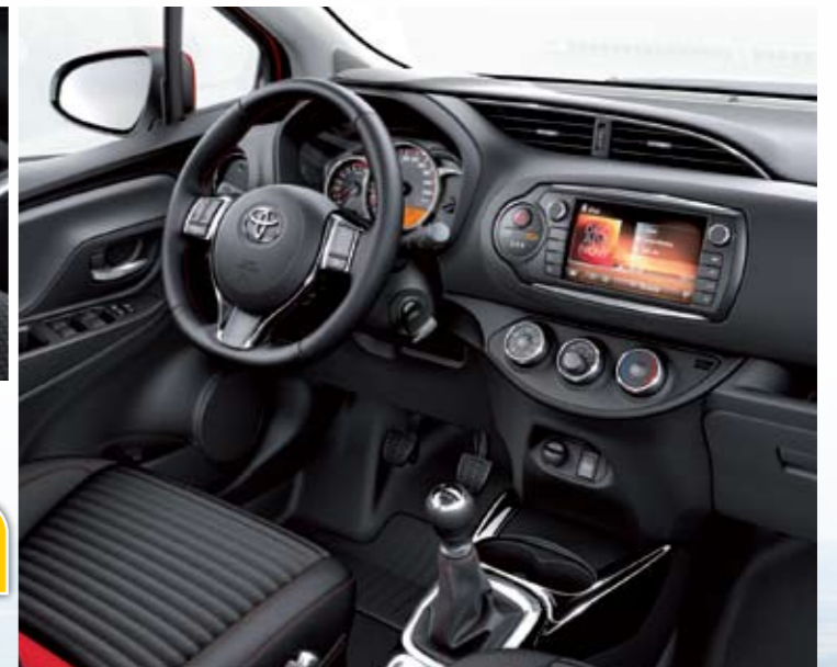
▶ La consola central se ha elevado 23 centímetros y se reduce en 30 mm la longitud de la palanca de cambio. También ha aumentado el tamaño de la pantalla táctil.
