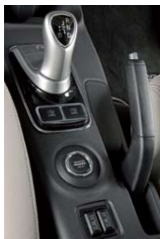
► El botón '4WD Lock' equivale al bloqueo de un diferencial central. Permite distribuir el par entre las 4 ruedas.
