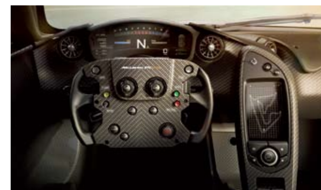
▲ Desde la parte superior del volante se controla también la aerodinámica del sistema Drag Reduction System (DRS) y el aumento de potencia Instant Power Assist System (IPAS)
