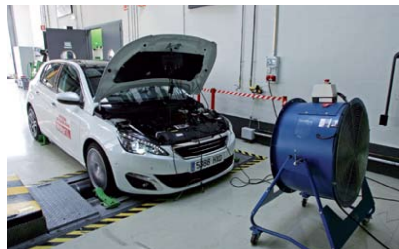
◀ Igual que hicimos cuando el coche tenía 10.000 kilómetros, nuestro protagonista ha sido sometido de nuevo al banco de potencia y ha superado una ITV con todas sus pruebas. El motor ha aumentado su potencia declarada y medida durante la primera prueba de 130 a 131, 55 caballos. Una gran cifra de un motor de tan sólo tres cilindros.
