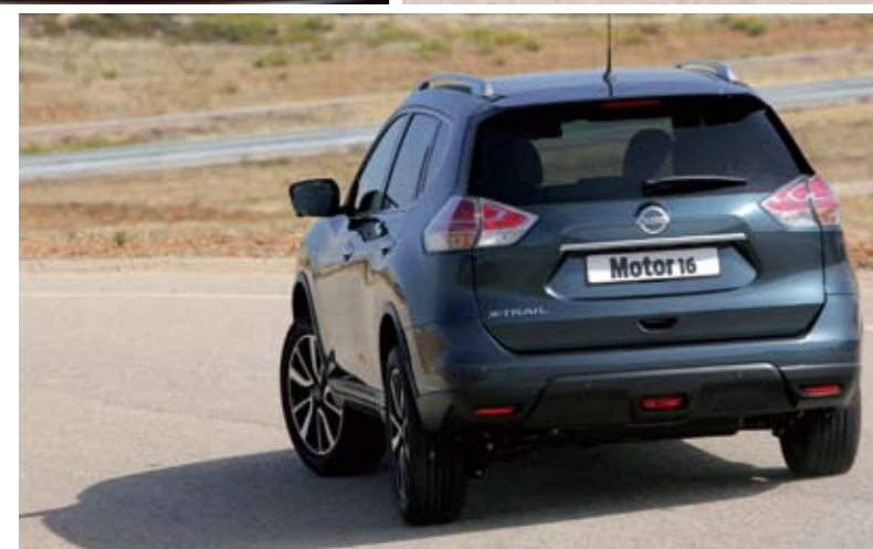
▲ El Control de Trazada Activo mide la velocidad, el ángulo de la dirección y la aceleración, aplicando frenadas selectivas para evitar el subviraje.
