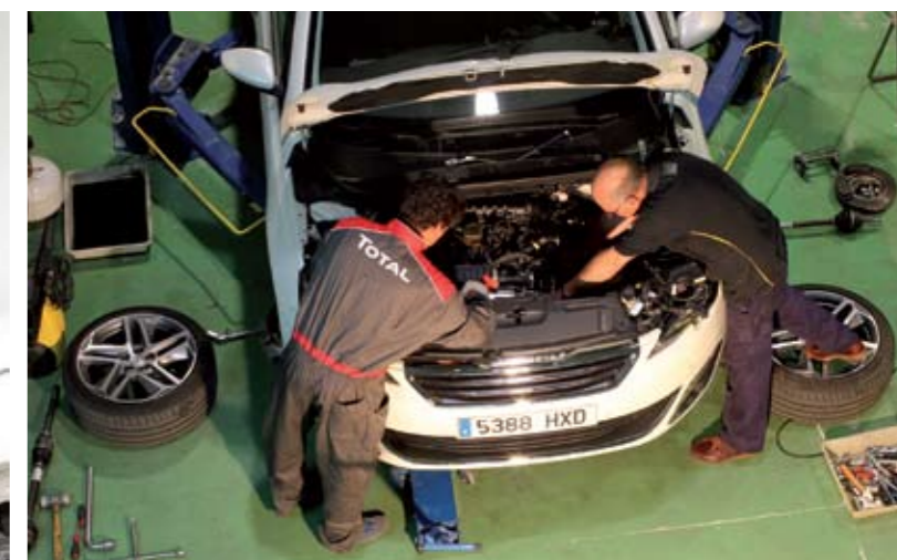
◀▲ Los mecánicos que desmontaron las piezas sometidas a mayor desgaste en plena faena. En el motor del 308 se trabaja sin pegas. Tras desmontar el McPherson delantero, Jose María Moreno procede a desmontar el disco.
