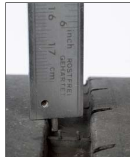
▲ Los canales labrados en los neumáticos, que sirven para evacuar el agua cuando se rueda con lluvia, están prácticamente intactos.
