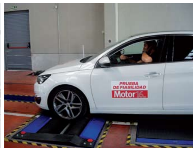
◀ Igual que hicimos cuando el coche tenía 10.000 kilómetros, nuestro protagonista ha sido sometido de nuevo al banco de potencia y ha superado una ITV con todas sus pruebas. El motor ha aumentado su potencia declarada y medida durante la primera prueba de 130 a 131, 55 caballos. Una gran cifra de un motor de tan sólo tres cilindros.
