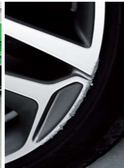
▲ Unas llantas muy expuestas pueden terminar fácilmente así.
