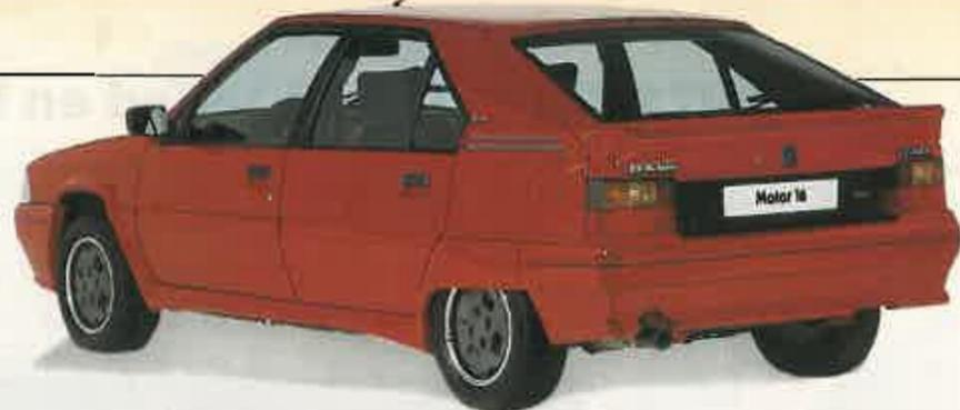
Al Citroën BX 16V, además de los elementos aerodinámicos, se le ha montado una salida de escape oval. Los tres 16 válvulas cuentan con llantas de aleación.
