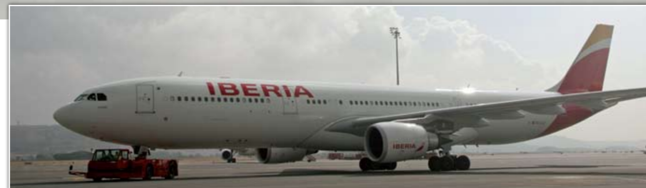
▲▼ Sin ayuda de ningún tipo por parte del avión, el 'push back' lo saca hasta el punto de rampa donde el avión pueda iniciar la maniobra de rodaje hacia cabecera de pista. La operación es muy delicada.
