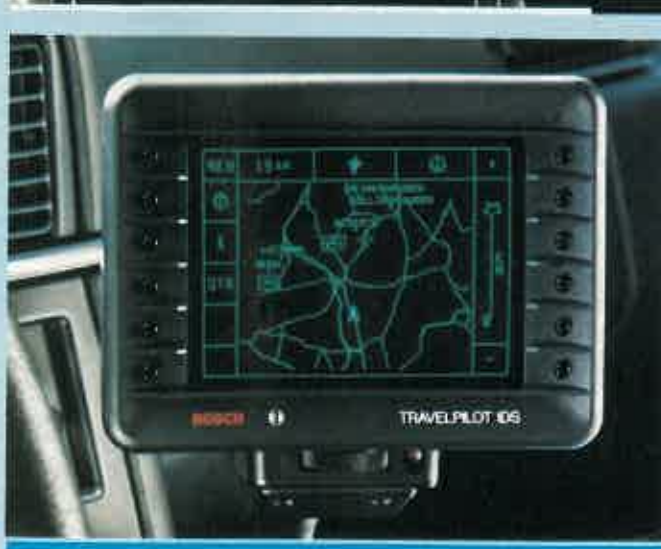
Una pantalla de vectores se encarga de proporcionar al conductor su posición y el punto de destino, así como la ruta más aconsejable que puede seguir en todo momento.
