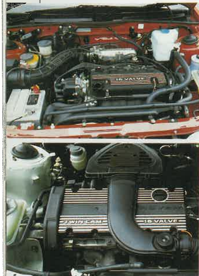
El motor de 1.4 litros que equipa al 214 es el primer ejemplo de la nueva serie K de motores contruidos por Rover. Más tarde llegará una versión con un litro de cilindrada. El 1.6 es Honda.
