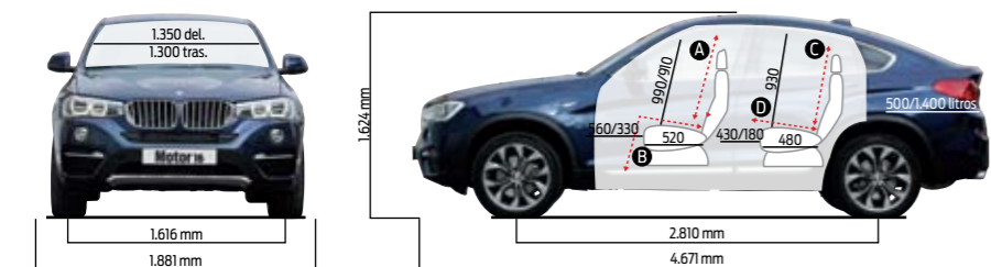
(A) Altura al techo (máx.-mín) 990 / 910 mm (B) Espacio piernas (máx.-mín) 1.080 / 850 mm (C) Altura del techo atrás 930 mm (D) Espacio piernas (máx.-mín) 910 / 660 mm
