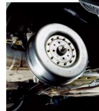
◀ Detalle de la rueda motorizada de Schaeffler, que ha sido realizada en cooperación con Ford sobre un Fiesta.
