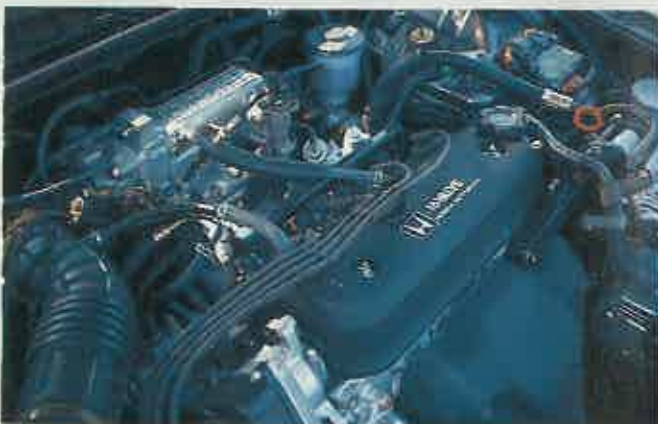
Un motor de cuatro cilindros tan suave como uno de seis. Dos árboles contrarrotantes eliminan las vibraciones.
