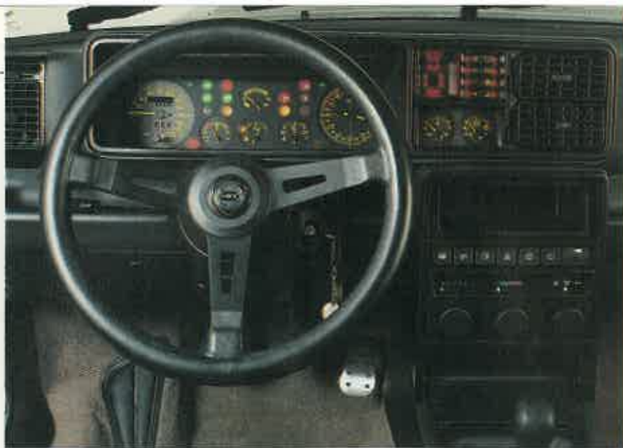
En el cuadro, una nueva disposición de la información en los relojes. El volante es regulable en altura y la climatización es algo pobre
