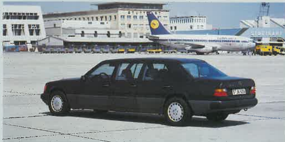
Un Mercedes de la serie W-124 pero muy especial, con seis puertas. El chasis ha sido alargado, con un aumento de la distancia entre ejes de 80 centímetros.
