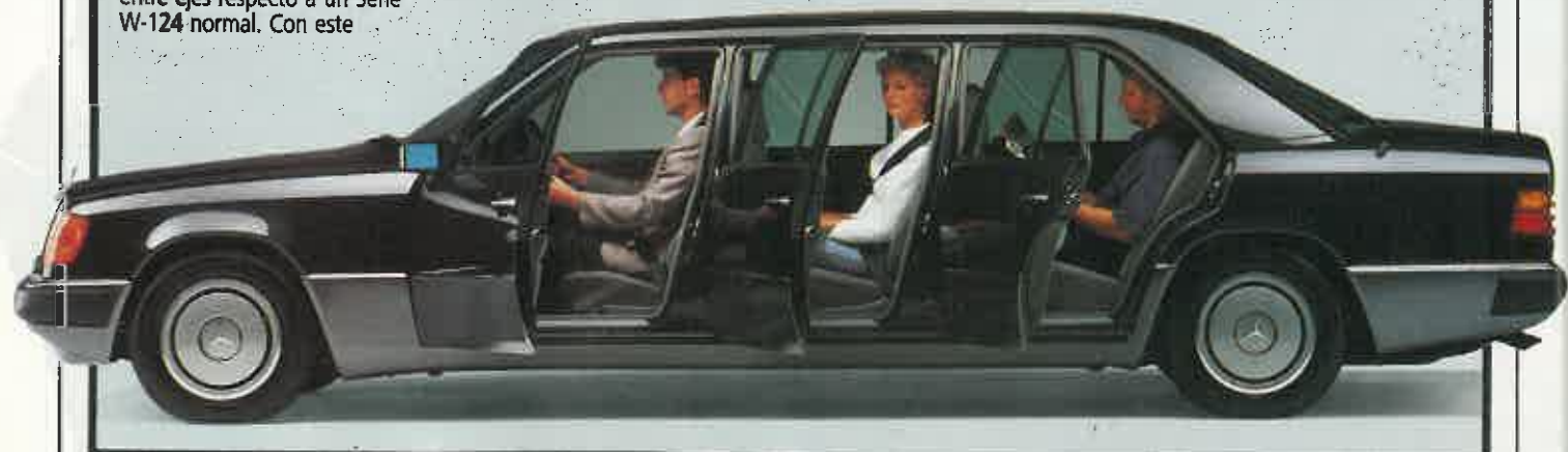
Un Mercedes de la serie W-124 pero muy especial, con seis puertas. El chasis ha sido alargado, con un aumento de la distancia entre ejes de 80 centímetros.
