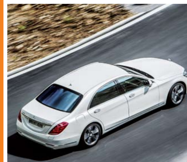
▲ El S 500 P lug-in Hybrid sólo está disponible en carrocería larga. El maletero pierde 115 litros (se queda en 395) debido a las baterías de iones de litio.
