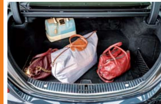
▲ El S 500 P lug-in Hybrid sólo está disponible en carrocería larga. El maletero pierde 115 litros (se queda en 395) debido a las baterías de iones de litio.
