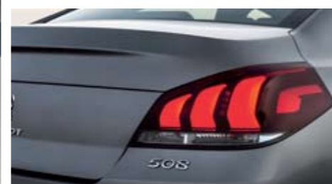
▶▶ Los grupos ópticos posteriores son 'Full Led' con 36 diodos.
