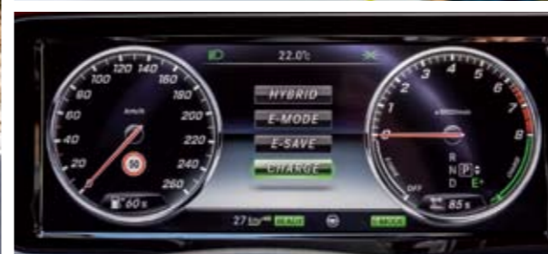
◀ Este modelo ofrece cuatro modos de conducción: 'Hybrid', el estándar; 'E-Mode', sólo eléctrico; 'E-Save', reserva la carga de las baterías; y 'Charge', las recarga en sólo media hora.
