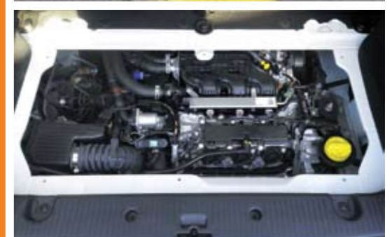
▲▲ 890 euros cuesta el techo de lona. El motor va bajo el maletero y hay que quitar una tapa para comprobar el aceite. La bandeja es frágil.
