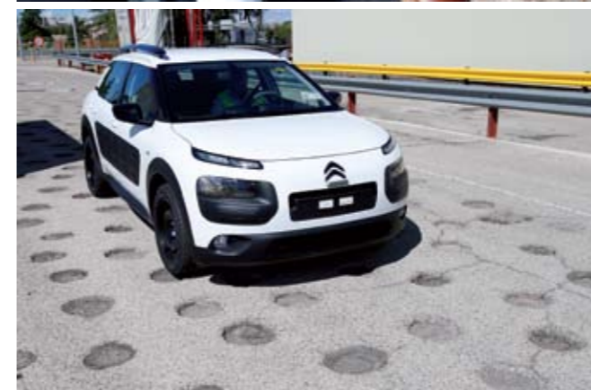
▲ Al salir de la línea de montaje, todos los Citroën C4 Cactus se someten a los rigores de una exigente pista de pruebas para comprobar que el vehículo se encuentre en perfecto estado.
