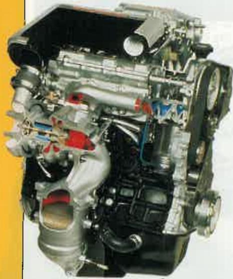
El motor de 2 litros con turbocompresor rinde 225 caballos, lo que supone una magnífica potencia específica.
