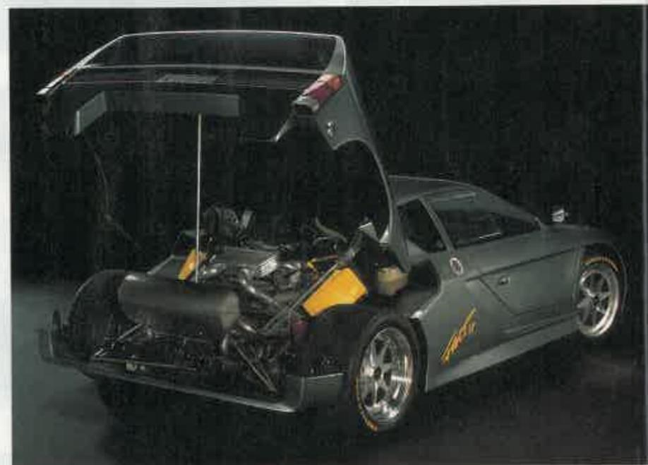
Al motor V8 de Audi se le han añadido dos turbocompresores. La potencia de este impresionante motor es ahora de 448 caballos.
