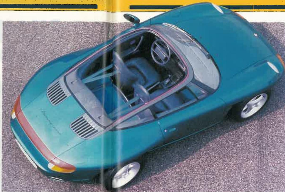
El Panamericana es un dos plazas con motor situado en la parte trasera y seis cilindros que dan 250 caballos. La tracción es a las cuatro ruedas y las soluciones mecánicas son en general las mismas del Carrera 4, modelo sobre el que se ha realizado este prototipo. Un techo duro desmontable con luna in-
