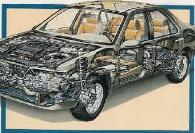
Los motores de seis cilindros se han ubicado transversalmente en el vano delantero. Los de seis cilindros funcionan con gasolina sin plomo. La suspensión trasera es de inspiración Mercedes.
