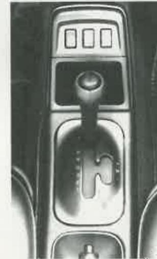
tipo automático, con las consiguientes posiciones habituales en este tipo de cambios. Pero en la posición «D» existe la posibilidad de presionar la palanca hacia la derecha, entrando en un segundo compartimento, señalado con la letra «M» de manual y que sólo permite movimientos hacia delante y hacia atrás. Cada vez que movemos la palanca hacia delante se aumenta una marcha, volviendo la palanca a su posición de reposo. Por contra, cuando movemos la palanca hacia atrás se reduce una marcha.
