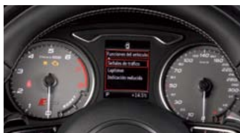
▶ En el S3, velocímetro tarado hasta 300 km/h y manómetro de turbo en vez de termómetro de agua.
