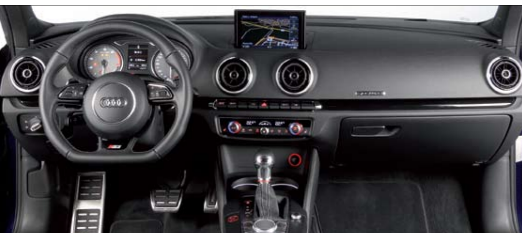
▶ En el S3, velocímetro tarado hasta 300 km/h y manómetro de turbo en vez de termómetro de agua.
