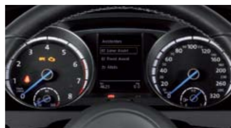
▶ El Golf R lleva el tope del velocímetro a 320 km/h y conserva el termómetro de refrigerante.
