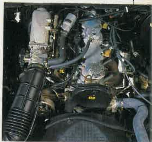
Nuevo motor 2 litros. La potencia es de 122 CV
