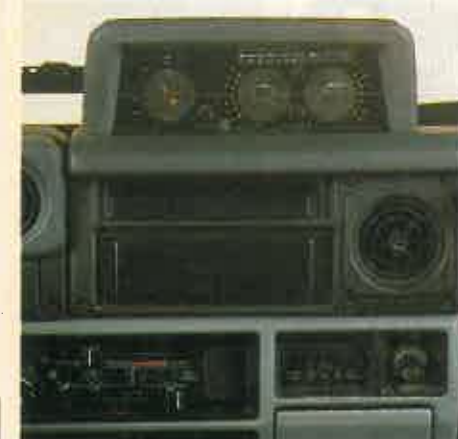
En el centro hay un cuadro con tres esferas. Dos inclinómetros y un altímetro.
