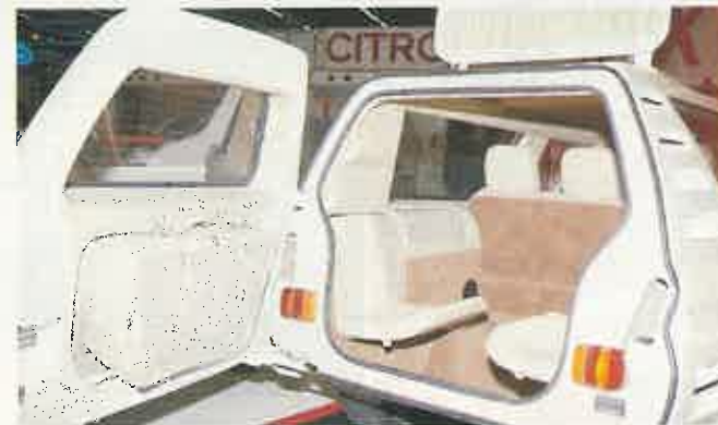
CITROËN AVENTURE. Funcional y superlujo. Ambos conceptos se unen en este modelo, que adopta soluciones originales, como la maleta acoplada al portón posterior.
