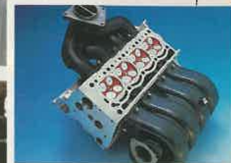
El R-21 Nevada llegará a España en los primeros meses del 87. La culata de cuatro válvulas por cilindro se instalará en el motor 1.700, abajo, la de tres válvulas.
