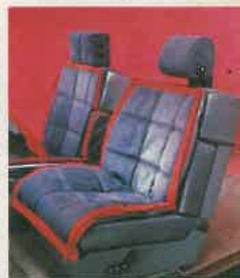
En un futuro no muy lejano, Renault ofrecerá en sus modelos el asiento Ergo. Un miniordenador memoriza tres combinaciones de reglajes diferentes. El asiento del pasajero tiene reposabrazos escamoteables.
