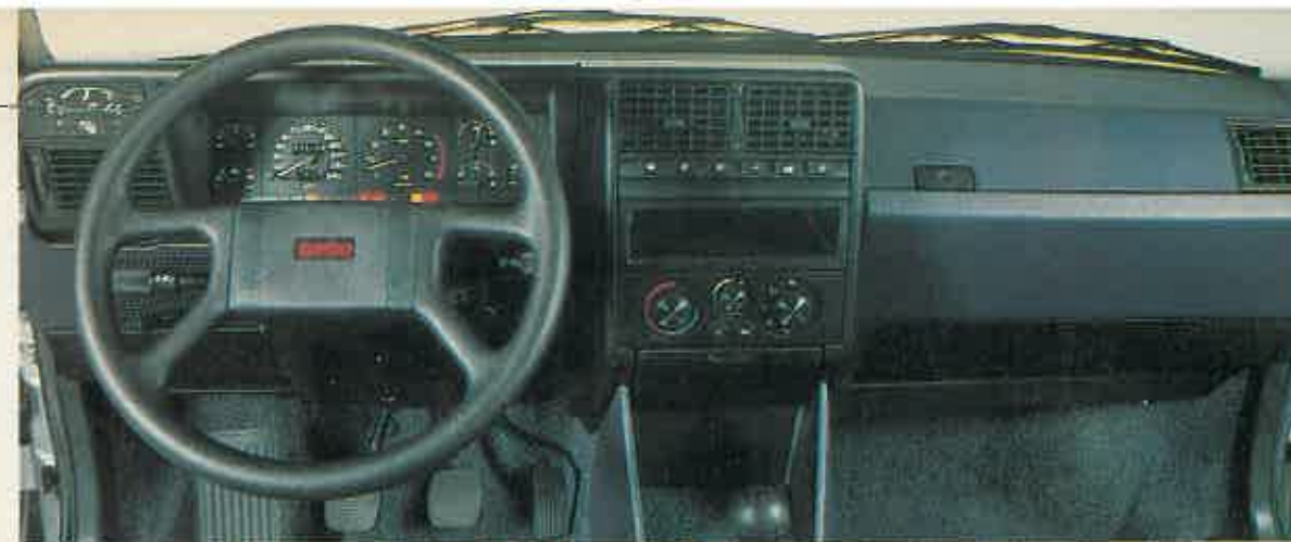
El cuadro de instrumentos es muy completo. Además el coche lleva un muy completo «check control». El volante tiene un buen tamaño y resulta agradable de empuñar.
