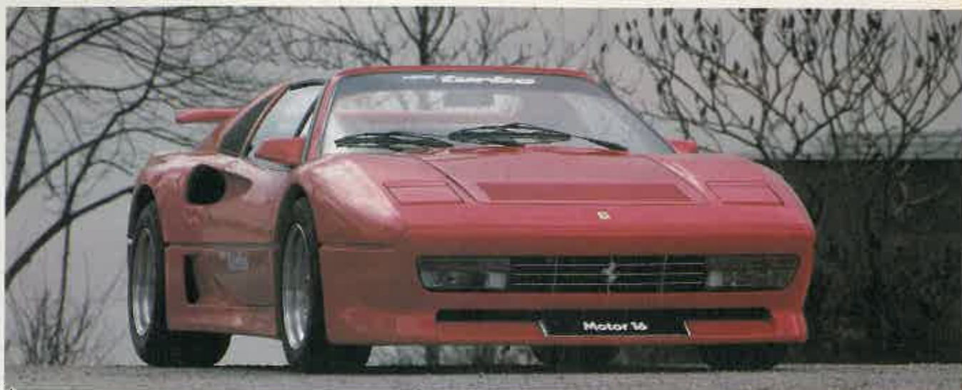
Koenig bate a Ferrari. El preparador alemán ha logrado superar las prestaciones del GTO con su 328 biturbo. El coche probado por MOTOR16 fue cronometrado en las autopistas alemanas a una velocidad punta de 306 kilómetros por hora.
