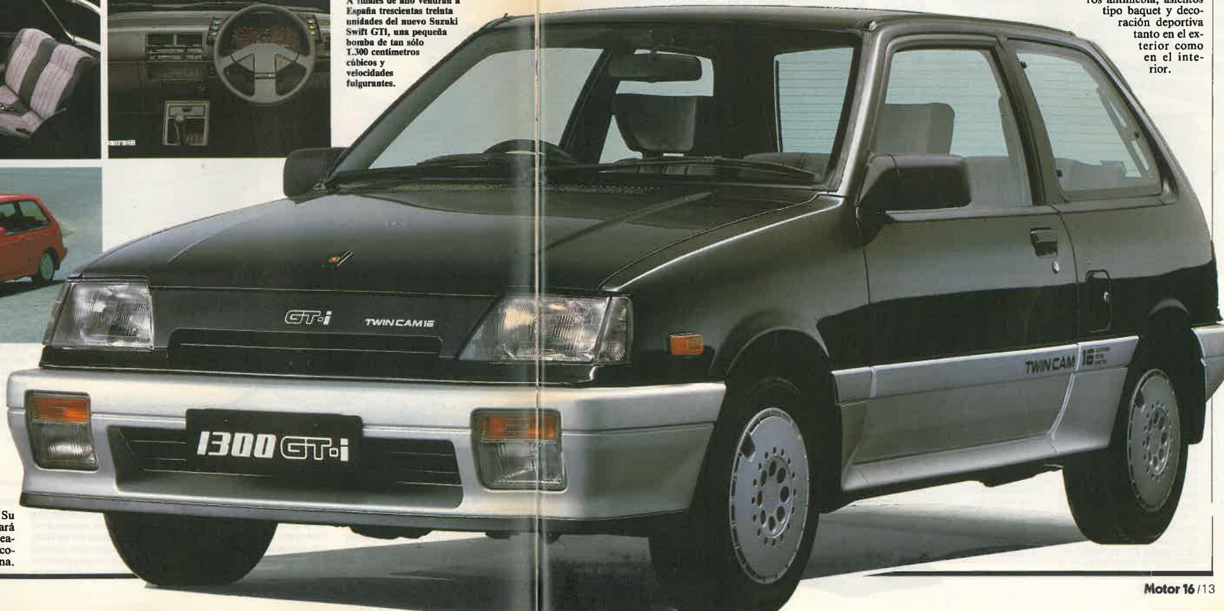
tiembre. El GTi es la versión deportiva de la gama. Incorpora un motor de 1.300 centímetros cúbicos, culata de cuatro válvulas por cilindro e inyección electrónica. Se trata de un coche de aproximadamente el mismo tamaño que un Peugeot 205, con carrocería de tres puertas y, en esta versión, con un equipamiento muy completo. Su comercialización se iniciará a finales de este año y se realizará a través de la red comercial de Suzuki Santana.
