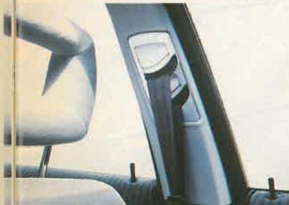
Como es ya habitual en los coches modernos, el anclaje de los cinturones de seguridad en variable, para ajustarse a cualquier conductor y estatura.
