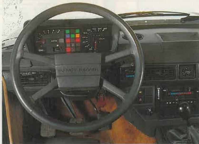
En el modelo con motor diesel la instrumentación está reducida a lo esencial. El cuadro de las versiones de inyección es bastante completo y de aspecto funcional.
