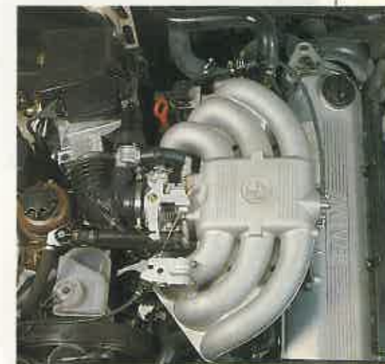
El motor desarrolla 171 CV. Es un 6 cilindros de 2,5 litros.
