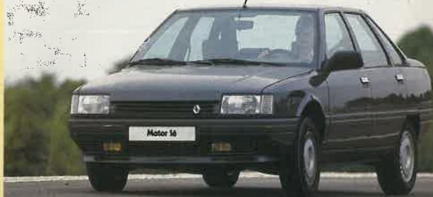
COMO ya la mayoría de los lectores conocen, el R-21 TXE utiliza el motor 2 litros (el mismo del R-18 GTX), ubicado longitudinalmente y alimentado por un sistema de inyección de marca Renix. El Citroën recurre al motor 1900' (el mismo del BX GT) con inyección Bosch LE-3 Jetronic. Pese a una menor cilindrada, el BX obtiene 5 caballos más (125) y eso que el motor, todo en aluminio, sólo
