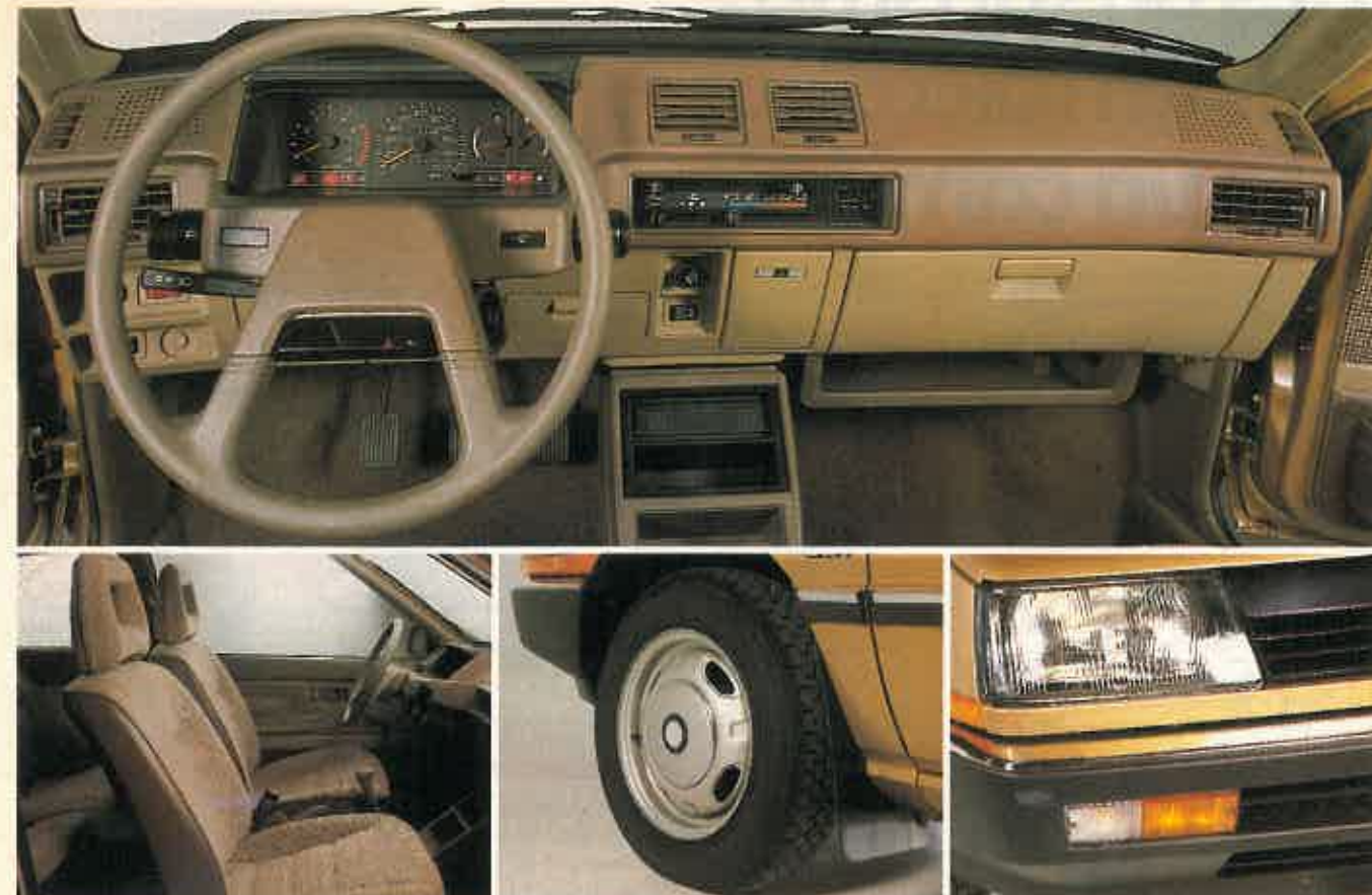
La posición de conducción es buena gracias a las múltiples posibilidades de regulación del asiento. Los neumáticos, unos 155 SR 13, resultan algo estrechos. Los faros proporcionan una óptima iluminación.
