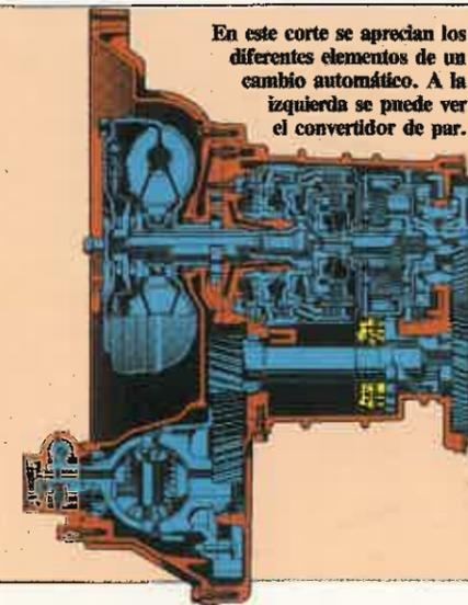
En este corte se aprecian los diferentes elementos de un cambio automático. A la izquierda se puede ver el convertidor de par.
