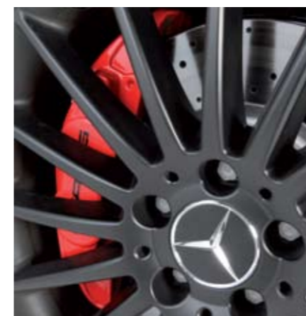
▲ Discos ventilados en ambos ejes: 350 mm delante y 330 detrás. De 120 km/h a 0, sólo 49 metros.
