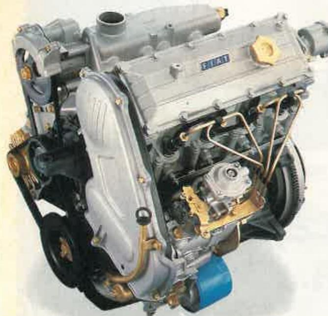
un ingenioso y eficaz sistema de inyección. Este motor 1600 se utilizaba en los Lancia Delta y Prisma y en el Regata 100 Super que no se importaba en España. Pero lo más ingenioso es el sistema de inyección con que se ha dotado. Normalmente, cada cilindro incorpora su propio inyector, pero en el Regata se ha instalado un
