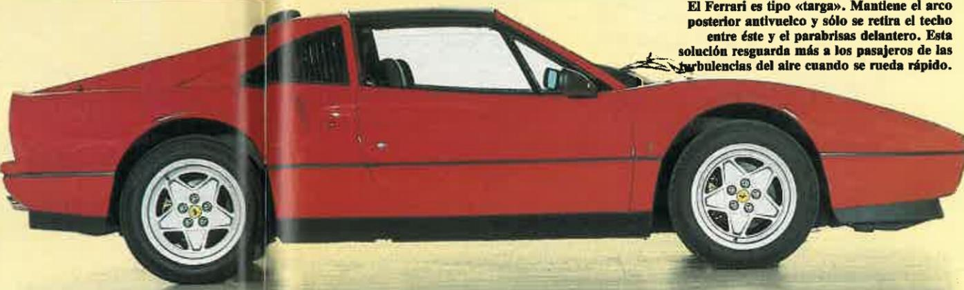
El Ferrari es tipo «targa». Mantiene el arco posterior antivuelco y sólo se retira el techo entre éste y el parabrisas delantero. Esta solución resguarda más a los pasajeros de las turbulencias del aire cuando se rueda rápido.
