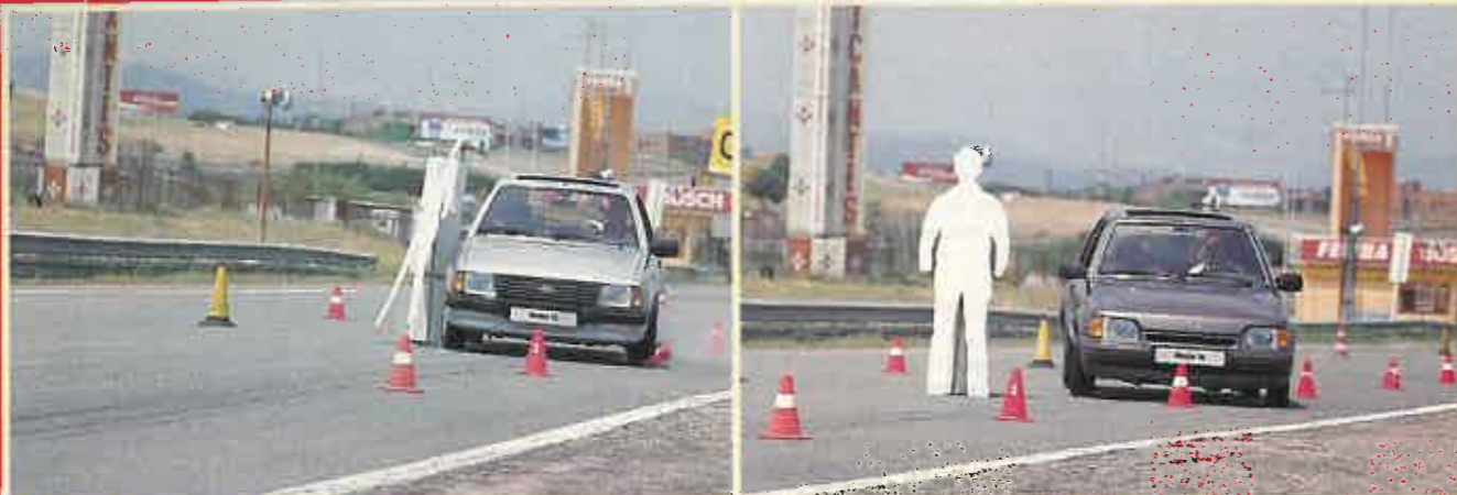
El Escort antiguo atropella al maniquí con todas las ruedas bloqueadas.
