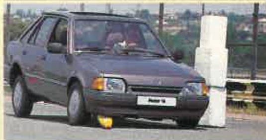
La diferencia entre uno y otro coche es abismal. El coche con SCS, el de color más oscuro, permite maniobrar aunque se lleve pisado a fondo el pedal de freno, algo imposible en el coche gris, sin SCS.
