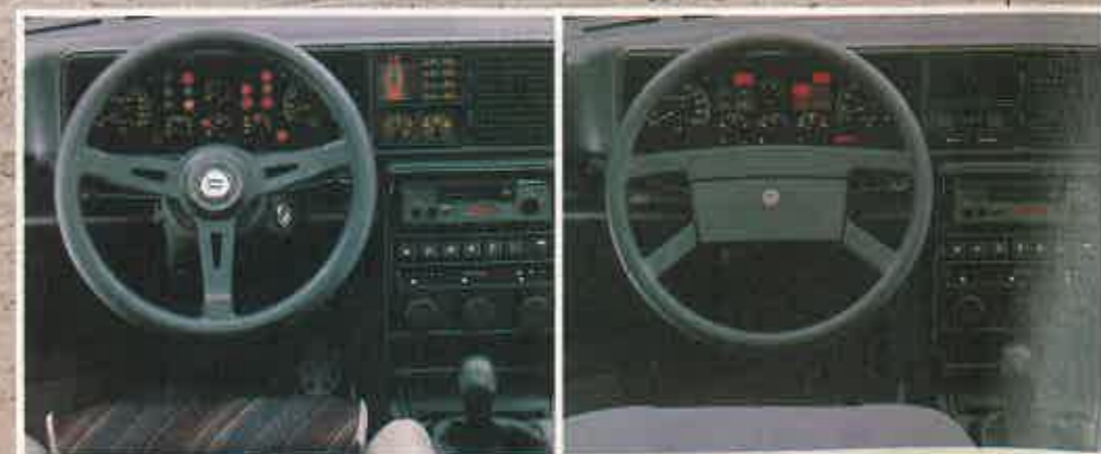
Cuadro de instrumentos de nuevo diseño. El del volante deportivo es común para el HF Turbo y 4WD.
