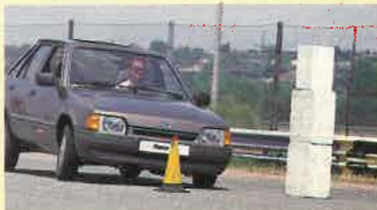
El modelo 86 con SCS evita el accidente gracias al poder directriz de las ruedas delanteras.
