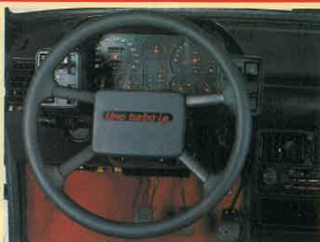
El Fiat tiene los mandos concentrados en dos satélites a ambos lados del volante, lo que requiere un cierto entrenamiento.
