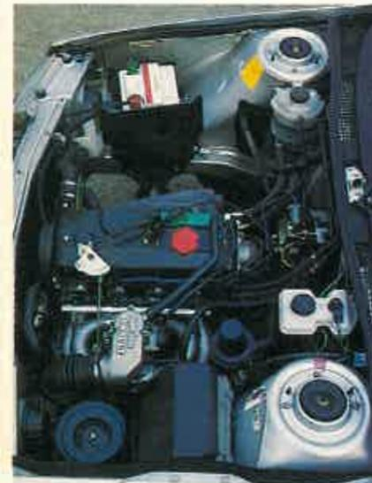
El motor dos litros va alimentado por inyección electrónica y colocado longitudinalmente. La versión TXE incorpora de serie ruedas de aleación ligera de aluminio.
