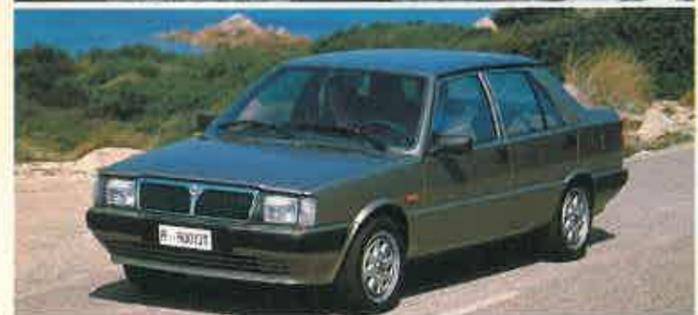
Con el motor 1.600 inyección se alcanzan los 185 kilómetros hora. Los consumos a 90 y 120 kilómetros/hora son de 6,2 y 8,0 litros a los 100 kilómetros.
