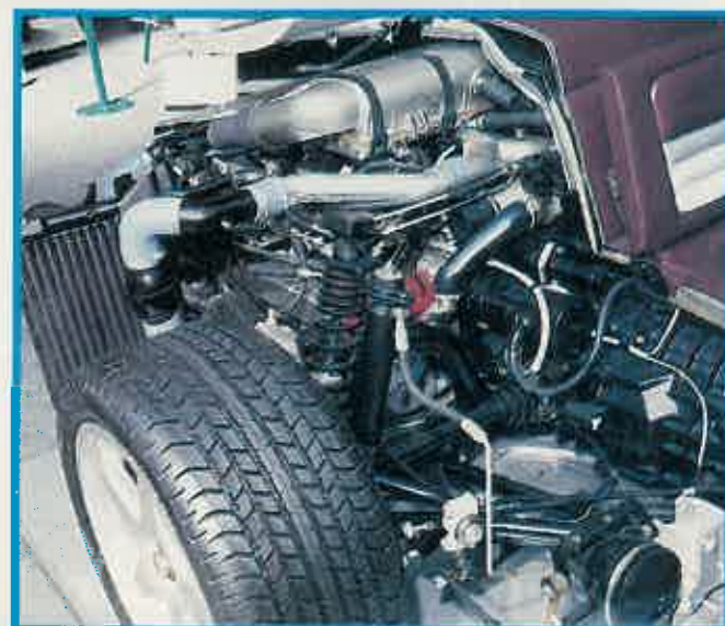
Sobre la suspensión posterior, una maraña de tubos y canalizaciones. Obsérvese la pareja de amortiguadores.
