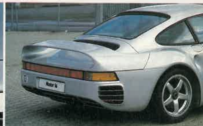
Lo más espectacular en alerones en coches de producción. Las ruedas traseras son enormes rodillos de 275 en perfil 40.
