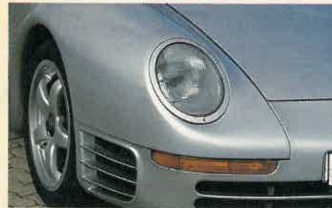
Coefficiente de penetración aerodinámica (Cx) de 0,31. Partiendo del 911 se ha logrado una carrocería muy perfilada.
