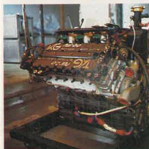
Motor TAG Porsche Es un seis cilindros en V a 80 grados. El padre de este motor es el alemán Hans Metzger. La potencia en carreras, de 850 caballos. No hay versión especial de entrenamientos. Sin precio oficial.
