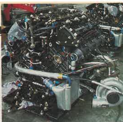
Motor Honda Es un seis cilindros en V a 80 grados. El padre de este motor es Yoshio Nakamura. La potencia en carrera supera los 800 caballos y llega a los 1.200 en entrenamientos. Sin precio oficial.
