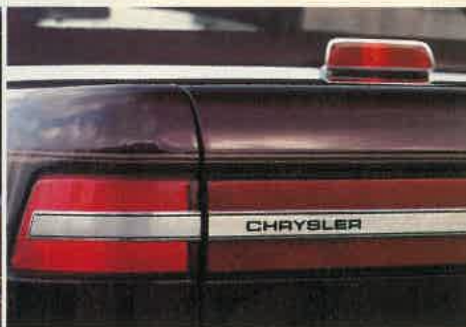
Piloto antiniebla y de freno sobre el maletero Así es más visible al circular en caravana
