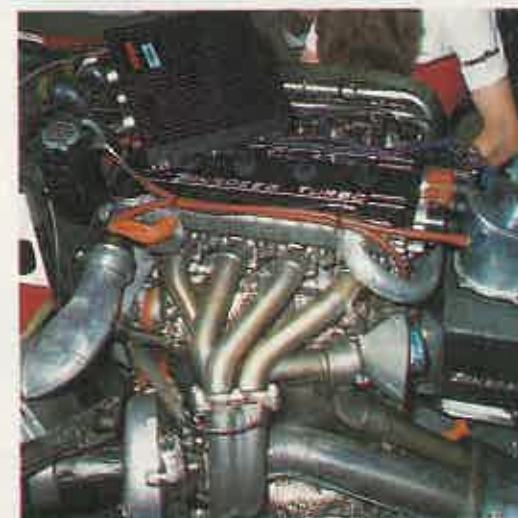
Motor Zak-speed Es un 4 cilindros en línea. Es obra del diseñador polaco Erick Zak-kowsky. La potencia en carrera supera los 700 caballos y llega a los 900 en entrenamientos. Sin precio conocido.
