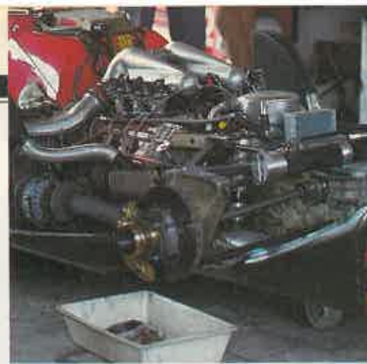
Motor Ferrari Es un 6 cilindros en V a 120 grados. Su primer diseñador fue Mauro Forghieri. La potencia en carrera supera los 850 caballos y los 1.200 en entrenamientos. Sin precio conocido.
