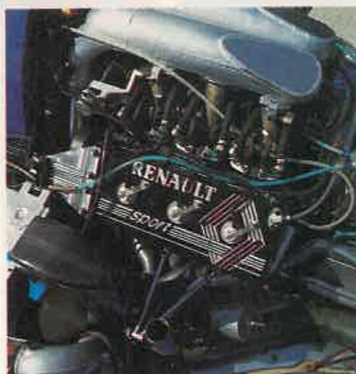
Motor Renault Fue el precursor de las mecánicas con turbocompresor. Lleva un sistema neumático de cierre de válvulas, 6 cilindros en V a 90 grados. 800 caballos en carrera, 1.000 en entrenamientos. Lotus paga 200 millones de pesetas. Ligier y Tyrrell más de 600.
