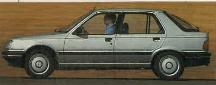
La versión GT se distingue por su mayor anchura de neumáticos y las llantas, con embellecedores tipo turbina.
