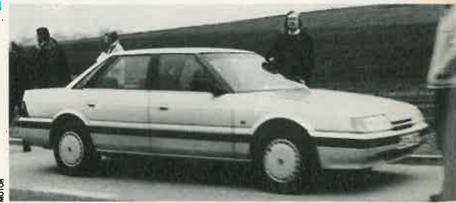
El Rover 800 se presentará en junio. Será un duro competidor para los familiares de máxima categoría. Utilizará dos distintos tipos de motores: un cuatro cilindros, de 140 caballos de potencia, y un seis cilindros en V, de 165 caballos, que debe superar con facilidad los 210 kilómetros por hora.
