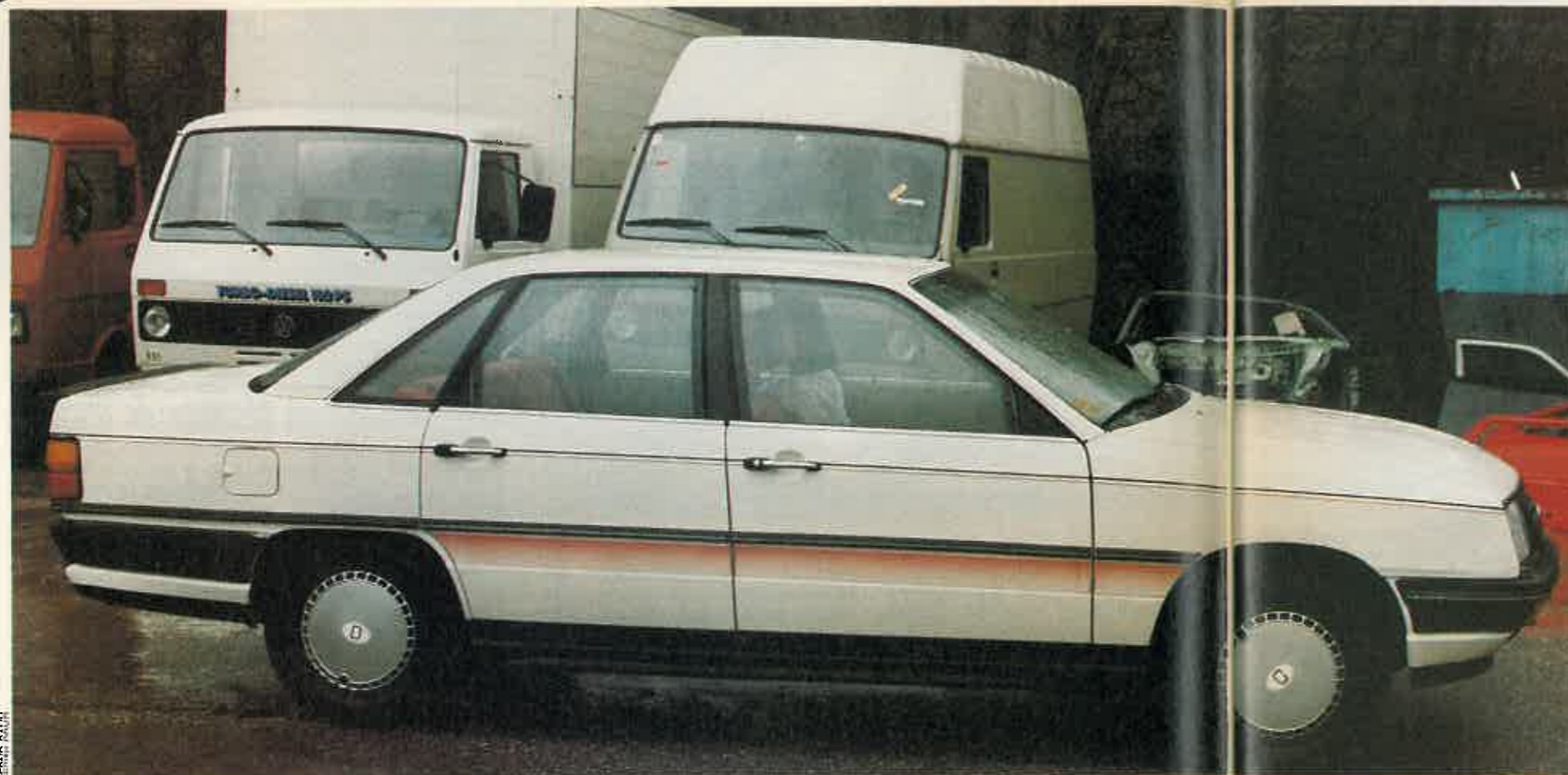
Aspecto casi definitivo del nuevo Audi 80. Con respecto a lo que se ve, en la foto sólo cambiarán los paragolpes y la parrilla delantera, que han sido tomados de un Opel Ascona para camuflarlo. El motor, como se puede apreciar, va muy adelantado, con el radiador a un lado.
