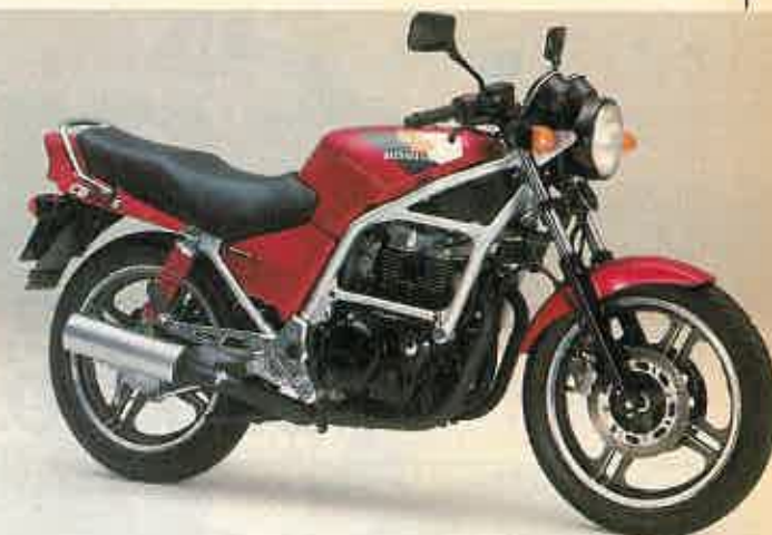
La Honda CB 450 está orientada a una utilización casi familiar. El chasis de tipo diamante da un toque de agresividad a todo el conjunto.
