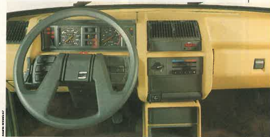
El cuadro del Málaga es completo, pero tiene detalles que rebajan puntos en el resultado final. El volante es regulable en altura, pero los mandos son bastante molestos.
