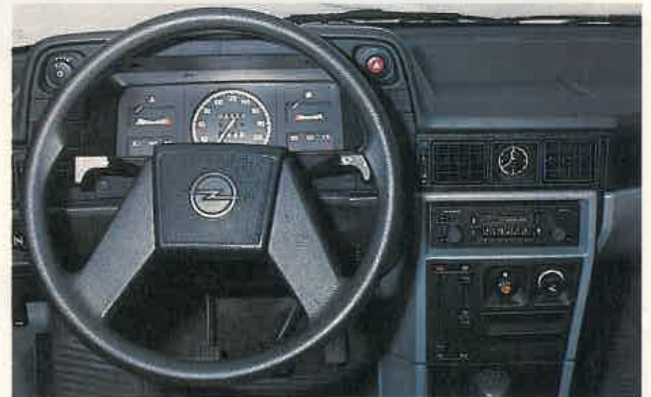
Cuadro de instrumentos del Kadett 1,6 D GL No tiene testigo óptico de reserva de carburante ni cuentarrevoluciones
