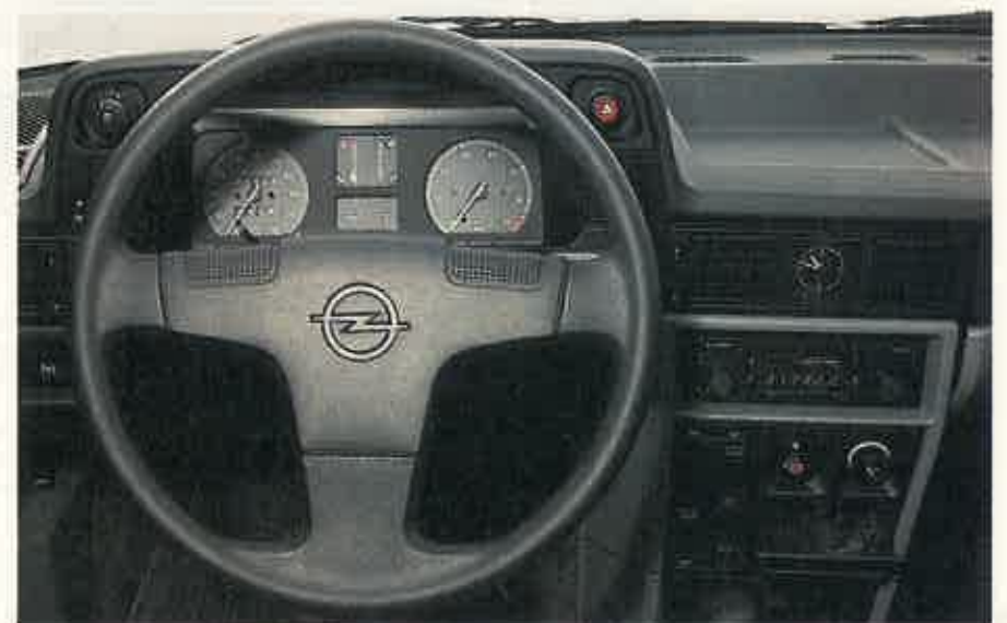
El cuadro de las versiones GLS es más completo que el de los otros modelos El volante es diferente y hay más testigos ópticos. El volante tiene un tacto y una forma excelentes
