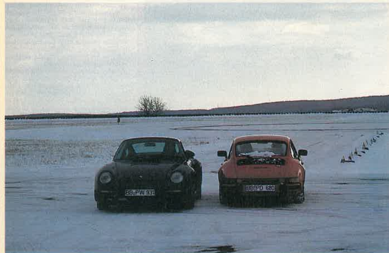
El 959 junto a un 911. Para economizar el proyecto, se tomó el bastidor de éste como base...
