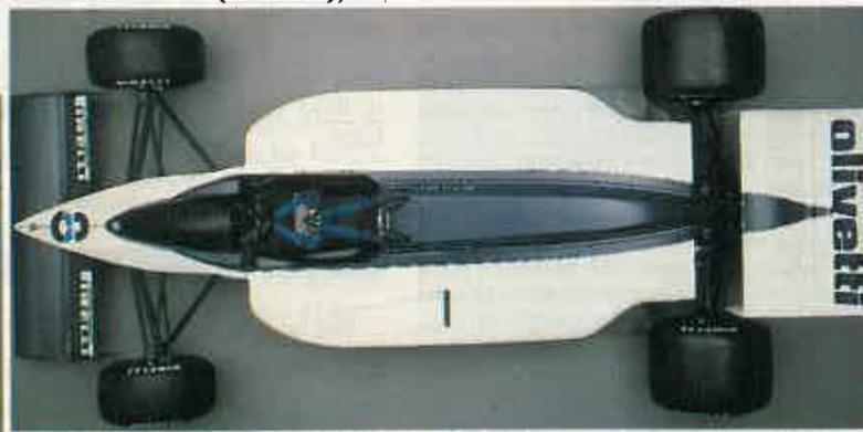
La diferencia de inclinación del motor BMW es notoria. En el Brabham-Olivetti BT-55 va prácticamente horizontal, mientras que en el anterior BT-54 iba vertical.
