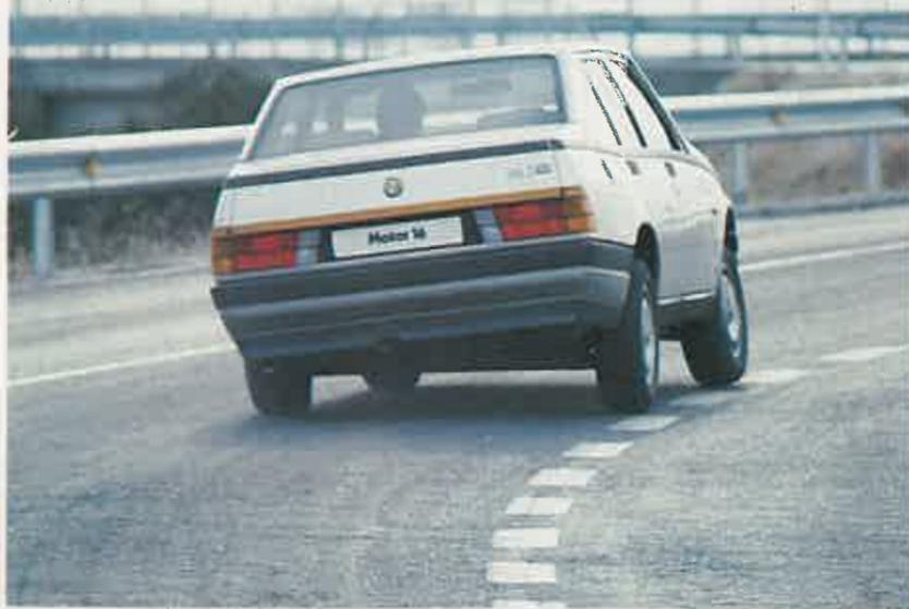
El comportamiento del Alfa es uno de sus puntos fuertes. A pesar de la inclinación de la carrocería, las ruedas permanecen verticales
