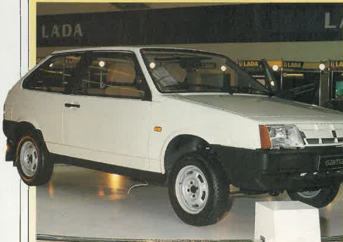
El Samara se distingue rápidamente por su original rejilla. Esconde los lavafaros y ayuda a la aerodinámica. El Cx es de 0,36
