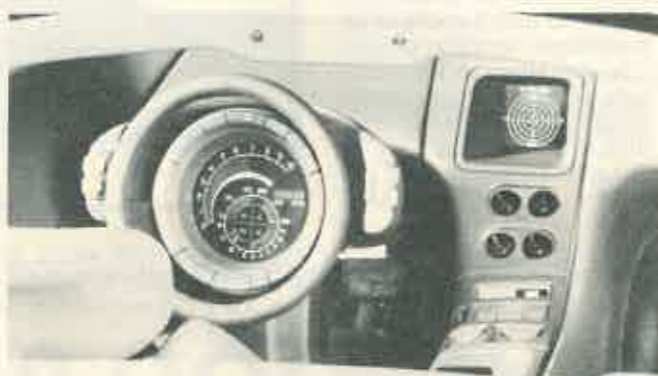
El cuadro de mandos del Buick es un monumento electrónico. Todos los datos importantes aparecen en el centro del volante.
