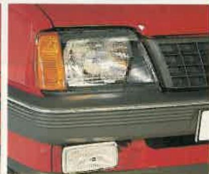
Los dos modelos utilizan faros halógenos
