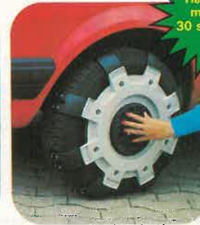
Reponer el anillo de sujeción y hacerlo engranar
