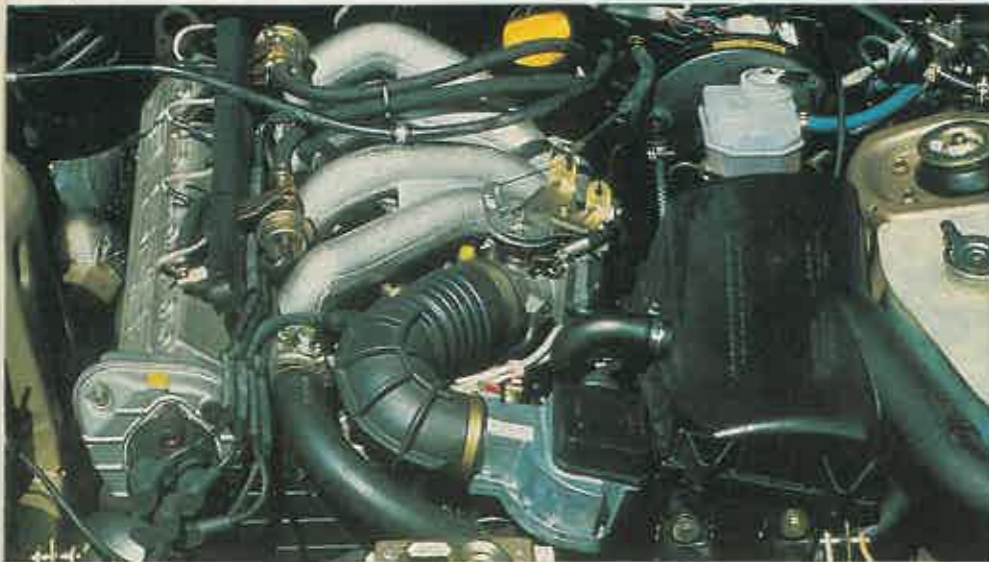
Es un motor suave y económico. Es el 2,5 litros del 944, pero con la potencia reducida a 150 caballos
