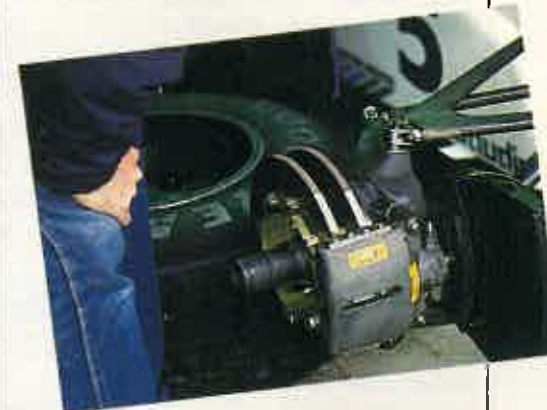
Frenos de doble disco. Williams insiste en esta nueva solución.
