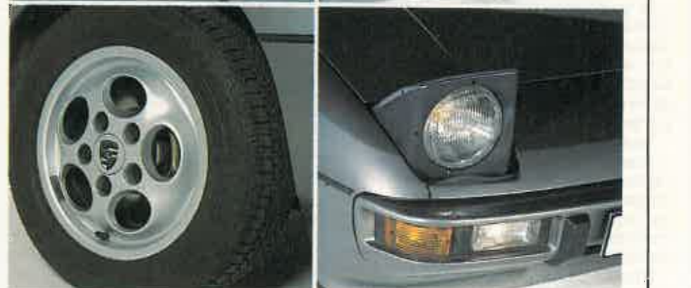
Sólo las llantas tipo 928 le diferencian de su antecesor. Los faros supletorios lanzan ráfagas cuando los faros principales van cerrados.
