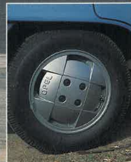
Las llantas son de chapa, incorporando estos embellecedores. Los neumáticos de serie son de perfil 82, en llanta de 13 pulgadas
