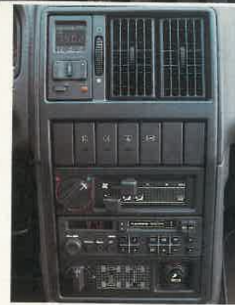
En la consola central está el interruptor que bloquea el diferencial central y el trasero. El equipamiento de serie es un poco pobre, pero se puede completar con una extensa gama de opciones.
