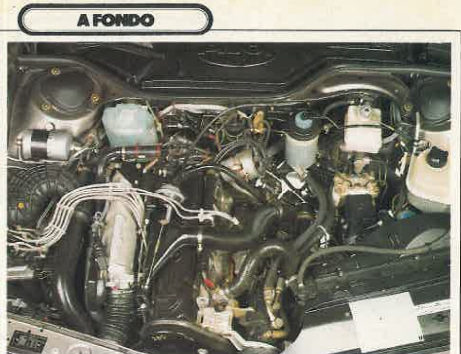
A FONDO El motor es el mismo de siempre. Un cinco cilindros con turbocompresor y con «intercooler», su funcionamiento es muy suave en todo momento. Sus consumos son sorprendentemente bajos para un coche que supera los doscientos kilómetros por hora, gracias en gran parte a la excelente aerodinámica de esta gran berlina, que marcó un nuevo estilo entre los coches de su categoría.
