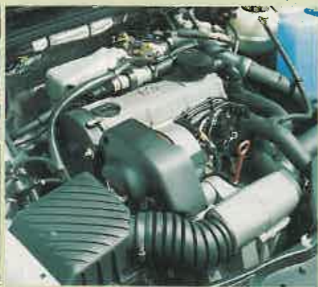
El motor de 1.8 litros y 16V se ha visto reforzado por el compresor G60 y con ello el rendimiento es excepcional, con 160 caballos de potencia.
