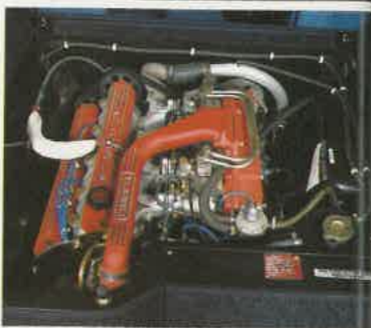
Motor central de cuatro cilindros turbo, capaz de alcanzar 280 caballos.
