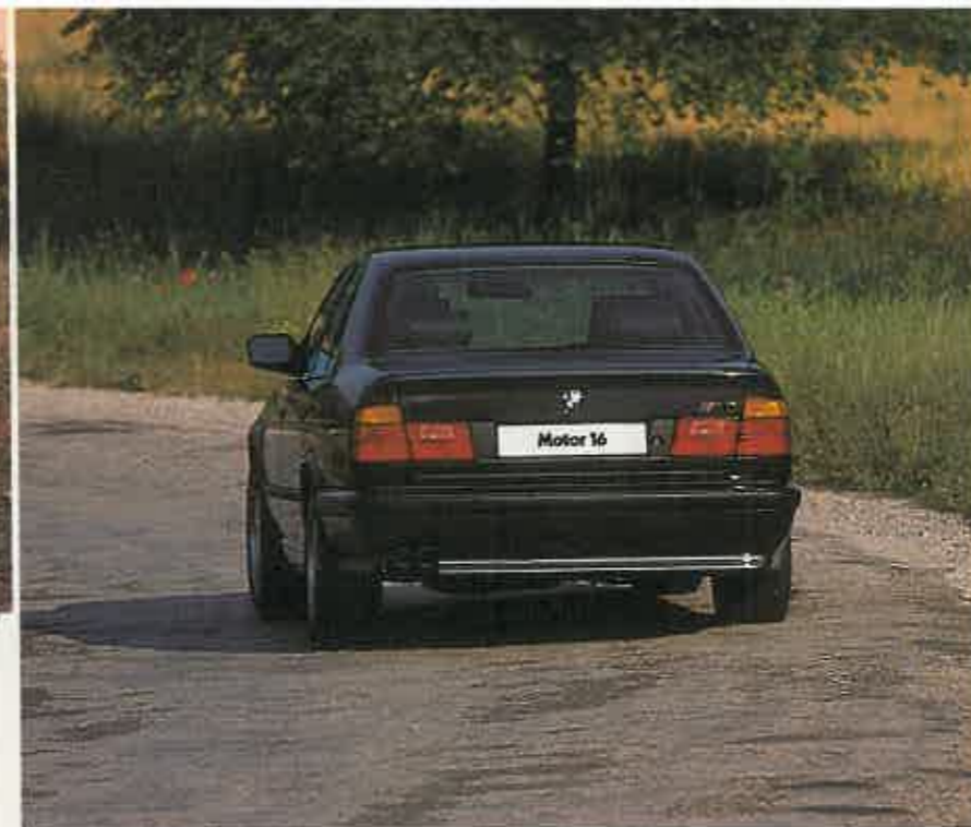
El M-5 ha sido rebajado en altura respecto a las demás versiones. Esto, junto a los nuevos spoilers, benefician el coeficiente aerodinámico
