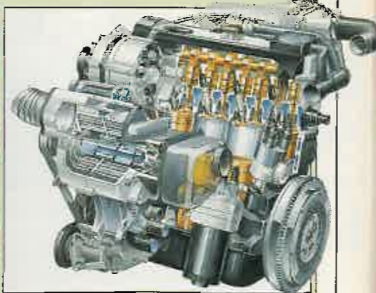
El motor de 1.8 litros y 16V se ha visto reforzado por el compresor G60 y con ello el rendimiento es excepcional, con 160 caballos de potencia.
