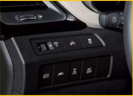
▲ El airbag de rodilla forma parte destacable del equipamiento de seguridad compuesto entre otras cosas por 9 airbags y un buen paquete de ayudas a la conducción. Desde unas teclas junto al volante se pueden activar ayudas como el control de descenso.
