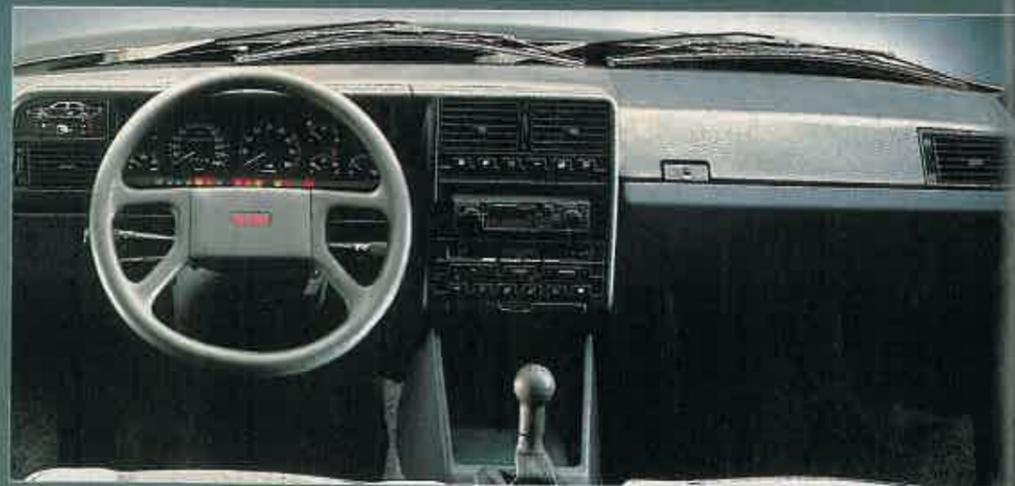
El diseño del salpicadero resulta vistoso y funcional. El «check-panel» controla trece funciones. Los mandos de ventilación son los de la versión con calefacción automática.
