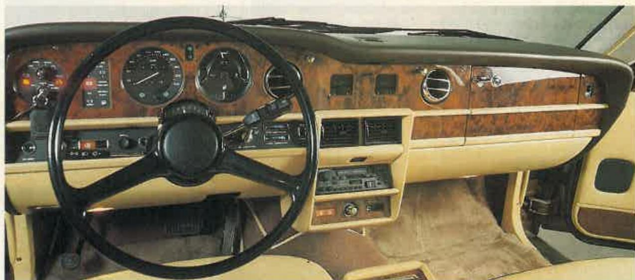
Salpicadero en madera de haya con una instrumentación muy clásica. El volante tiene un aro muy fino. Y el selector del cambio va en la columna de dirección. En la consola central están los mandos de los retrovisores y el reglaje de los asientos. En la parte trasera, el aparato de vídeo.
