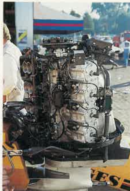
Así son los poderosos motores de Fórmula 1 Ocho cilindros, dos tiempos, para 600 caballos
