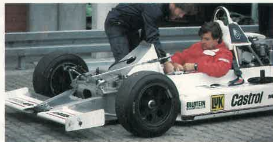
Las cosas se ven muy distintas desde dentro. La bañera de metal que rodea el cuerpo del piloto aprisiona pero también da seguridad.
