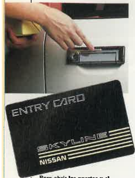
Para abrir las puertas y el maletero se utiliza una tarjeta magnética.
